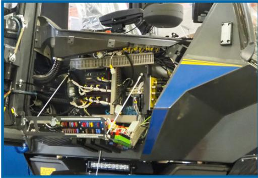
Die Schaltzentrale mit Sicherungen, Relais und Rechnern ist übersichtlich strukturiert und durch Öffnen der rechten Kabinentür optimal zugänglich.
